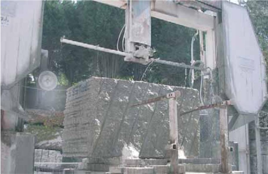
Su funcionamiento es similar al de los equipos utilizados en cantera, con las diferencias de que la unidad motriz es fija, y que el número de hilos puede ser variable. Consta de una estructura metálica en forma de puente, debajo de la cual se colocan uno o varios bloques. Dos poleas conducen el hilo, y unos contrapesos presionan el hilo sobre el bloque. La unidad motriz hace girar el hilo rozando contra el bloque. Para la prevención del polvo y refrigeración del hilo se utiliza agua.
