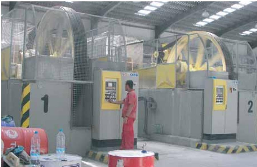
máximo número de tablas posible con las dimensiones que previamente se han ajustado. Además, a medida que avanza la operación, el operario/a debe detener el telar y fijar las tablas para evitar roturas y, por tanto, pérdidas de material.
