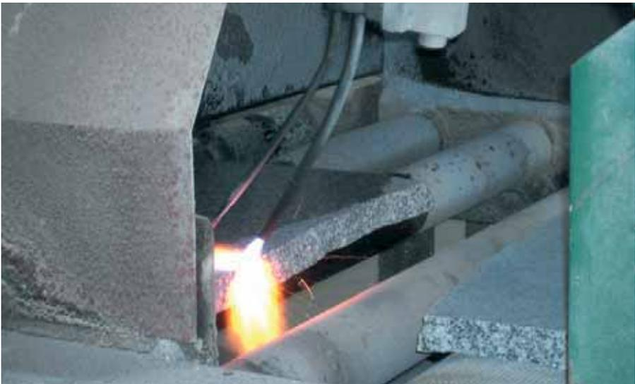
El flameado puede realizarse automáticamente (en el interior de las naves) o de forma manual (en exteriores). Cuando se trata de un proceso automático, la máquina es similar a la utilizada en el abujardado, pero sustituyendo la bujarda por un soplete o quemador que, sujeto a un brazo, recorre la superficie de la pieza a tratar. En el caso del flameado manual, un operario/a es quien realiza la operación.
