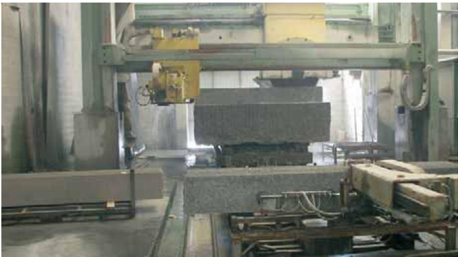
Las encabezadoras realizan cortes perpendiculares a la pieza a elaborar. Tras estos cortes el operario/a clasifica y retira los sobrantes. Las piezas cortadas son colocadas por los/as operarios/as sobre palets, clasificándolas según color, calidades, etc.
